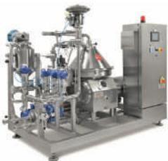
La centrifugation est la technique de polissage et de filtration la plus économique. Les pertes de bière sont réduites et les qualités organoleptiques de la bière sont protégées. L'étanchéité des centrifuges REDA est effectuée par un anneau liquide qui évite tout risque d'oxydation du produit.
