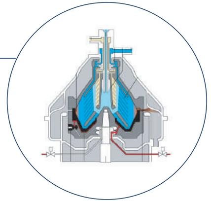
**L'étanchéité** est effectuée par un anneau liquide qui protège le produit de l'oxydation. Ce système réduit considérablement les frais de maintenance et facilite les entretiens.
