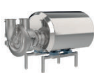
ASH 40 m³/h - 35 mcl. GM, palier dans la lanterne, corps moulé. Ra < 0,8 ou 0,5 µm, certificats. Drain en option. Configurations spéciales sur demande.
