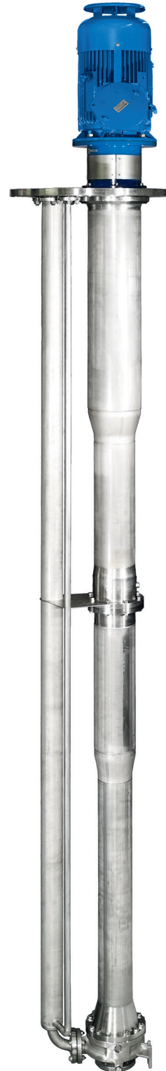
MKTP avec moteur avec conduite de refoulement rechauffé, chaise palier (-20 °C à +170 °C), verticale
