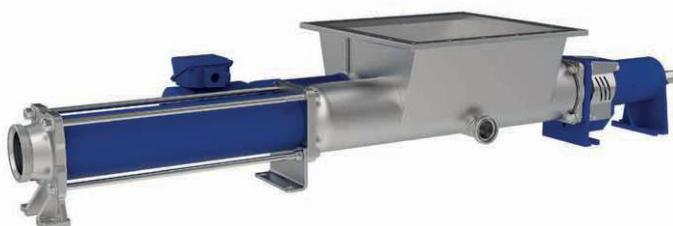
Les pompes à vis excentrée peuvent pomper quasiment tout type de fluide, newtonien ou non, jusqu'à 800.000cP, abrasif ou contenant des particules solides en suspension. Elles sont caractérisées par une délicatesse de pompage, sans effet pulsatoire et un débit directement proportionnel à la vitesse de rotation.
