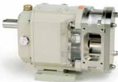
Les modèles B115, B220, B330, B440 et B490 sont réalisés avec l'orifice d'aspiration à section rectangulaire pour faciliter l'alimentation de la pompe lors de produit à haute viscosité ou des produits pâteux avec des morceaux semi-solides.
