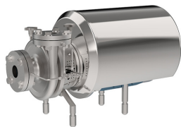
CSD (aseptique) 300 m 3 /h - 100 mcl Rendement élevé, faible NPSH. En option : Inducer, Certificats, Ra < 0,5 µm et configurations spéciales sur demande
